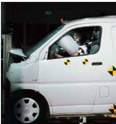
Det stødabsorberende karrosseri viser sin styrke, hvis uheldet er ude. Det forlængede frontparti optager størstedelen af kræfterne, hvorefter resten af energien absorberes af de langsgående vanger. Kabinen er yderligere forstærket, så deformation stort set undgås.
