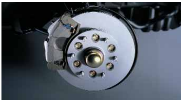
Bremsekraften er rigelig med 15" ventilerede skivebremser fortil. De tåler gentagne hårde opbremsninger uden tendens til fading og deraf nedsat effektivitet.
